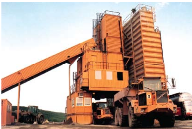
Bild 5 Heilit+Woerner Mischanlage im ISO-Seecontainer-Maß
