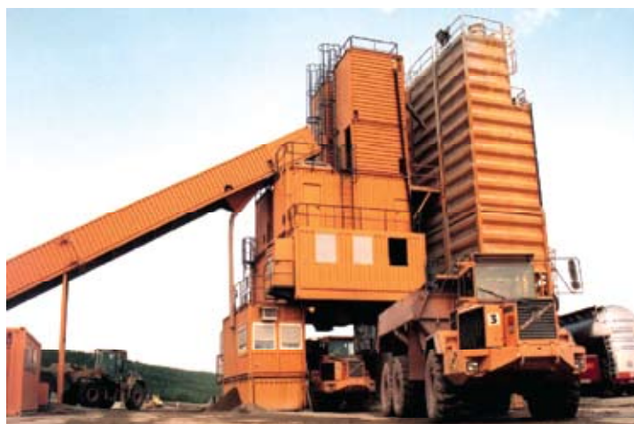
Obrázok 5 Miešacia stanica Heilit+Woerner v normovanej veľkosti námorného kontajnera ISO
