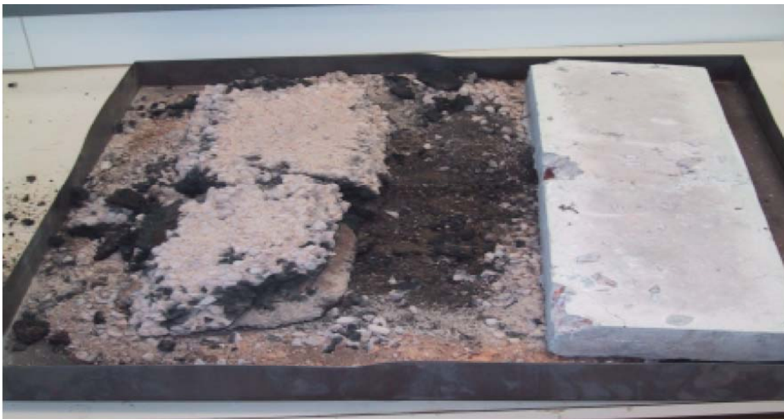
Obrázok 1: Porovnanie vzoriek asfaltu (vľavo) a betónu (vpravo) po zohriatí na 750°C
