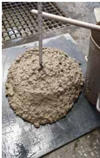
Obrázok 4: Skúška sadnutím kužeľa zmesi 2 po 5 min.
