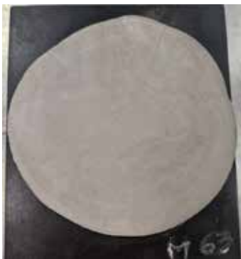
Obrázok 3: Skúška rozsahu plastického zmrašťovania separátne mletého cementu CEM II/C-M (S-LL) 42,5 N
