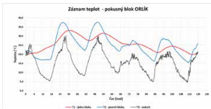
Obr. 4: Záznam teplot v jádru (T1), na povrchu (T2) zkušebního bloku a okolního vzduchu (T3) při betonáži skluzu VD Orlík.
