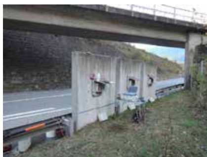
Obrázok 2a a 2b – Testovacie prvky s výstupom meracích senzorov a so zberom dát
